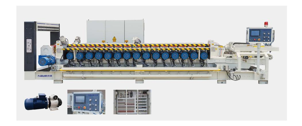
该设备用于瓷砖、石材规格板、复合板的磨边和倒角,该机设有对中和推板 机构,加工精度高,对角线误差小。
